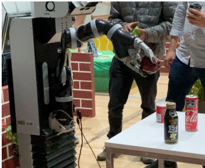
Figura 19: Detectar y recoger una manzana.
